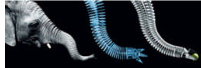
Bionic Handling Assistant, inspiré de la trompe de l'éléphant
