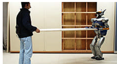
Transport d'une table par un humain et le robot humanoïde HRP-2
